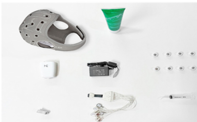
Figura 2. Materiales (gorro de neopreno, Starstim® 8, clip para oreja, gel Sigma, cargador, juego de cables, NGPistim y jeringa).
