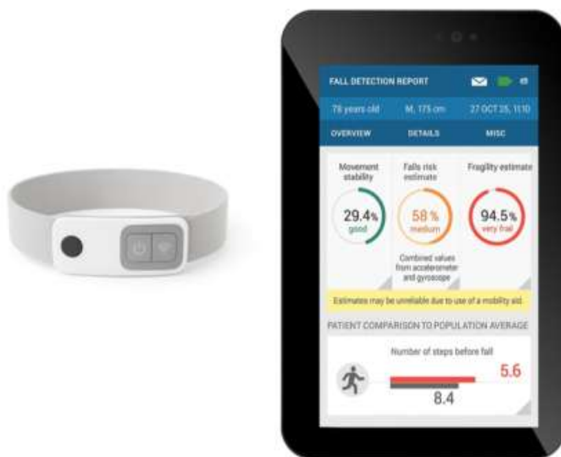
Figura 1. Ejemplo de dispositivo portátil para caídas.
